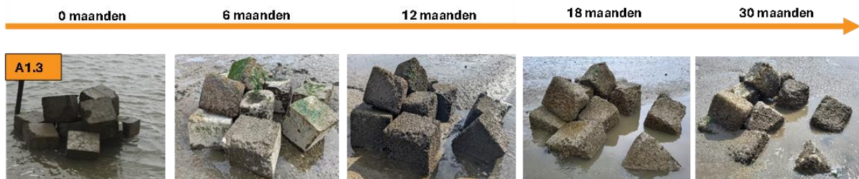
Chronosequentie van de rifblokken. Jaar 0-1: – initiële erosie; jaar 1-2: ontwikkeling van groene lagen, wieren en biofilm. Ruw oppervlak en vestiging van zeepokken en slakken. Jaar 2-4: vestiging van mosselen en oester op het ruwe oppervlak
